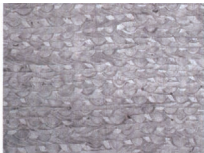
图2 Dimetal-280成型316L不锈钢件微观组织
